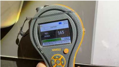
Fuktsøk ved befaring avdekkes ingen unormale avvik.
