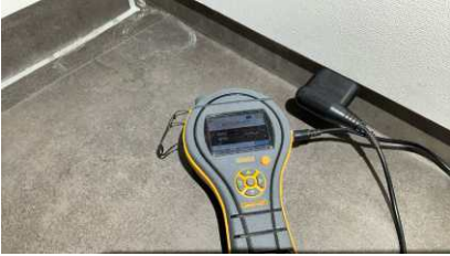
Fuktsøk i våtsone på bad uten å påvise unormale forhold.
