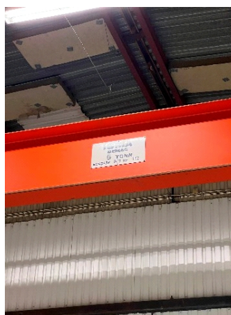
5 tons traverskran fra 1979.
