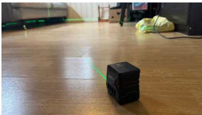
Kontroll av planavvik/ skjevheter i gulv.
