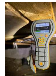
Fuktmåling med pigger i krypkjeller ga ingen forhøyede verdier.
