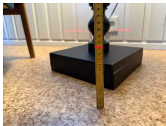
Punktmåling av gulv på loft.
