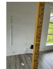
Stue 128 cm, avvik på 9mm målt i en diameter på 2m.
