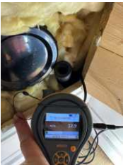
Målt 12,9% noe som er tørt. Målt med MMS2 korrigert for nordisk I bod er det indikasjon på fukt i betong. Målt mitt i rommet. trevirke.
