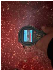
Målt 12,9% noe som er tørt. Målt med MMS2 korrigert for nordisk I bod er det indikasjon på fukt i betong. Målt mitt i rommet. trevirke.
