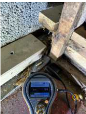
Målt 12,9% noe som er tørt. Målt med MMS2 korrigert for nordisk I bod er det indikasjon på fukt i betong. Målt mitt i rommet. trevirke.
